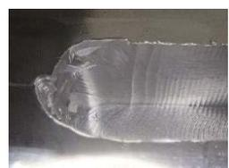
Rupture due au bourrage des copeaux
